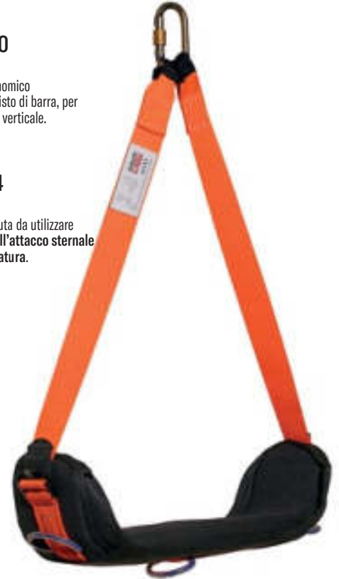
AKIS01 FASCE DI SOSPENSIONE Applicabili a tutti i tipi di imbracature. Appositamente studiate per alleviare gli effetti negativi di una temporanea sospensione a seguito di una caduta. In caso di necessità, estrarre le due fasce, legarle tra loro e appoggiare i piedi sulla fune di sospensione ottenuta, in attesa dei soccorsi (vedi foto). Confezione: 1 paio
